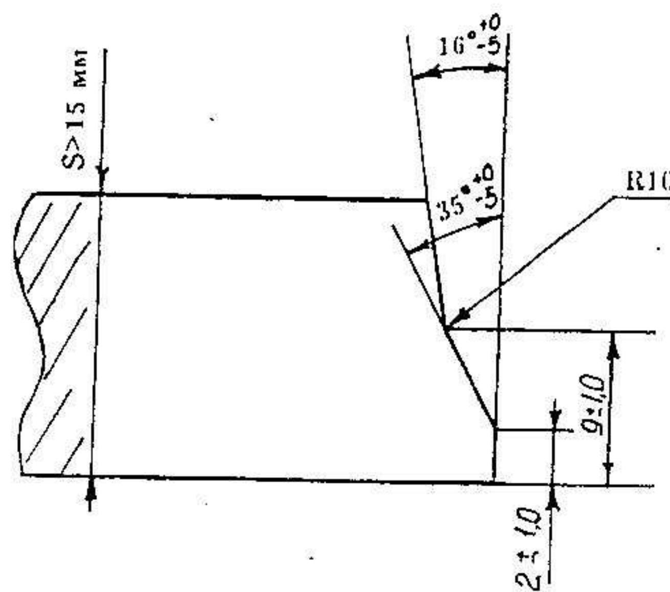
Рис. 1 Разделка кромок торцов трубы.
